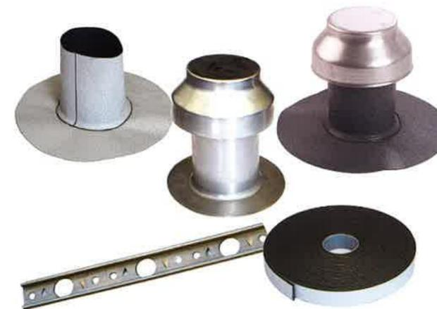
Um positiven Druck unter der Bedachung und die Wirkung von möglichen Luftlecks in der Konstruktion zu eliminieren, werden speziell konstruierte Ventile eingebaut. Die Ventile wirken nur in einer Richtung und lassen Luft entweichen, jedoch nicht eindringen. Allgemeine Regel: zwei Ventile in jeder Ecke (Innen- und Außenecke), ein Ventil im Randbereich pro 15 Laufmeter. Für gewöhnlich werden keine Ventile an höheren angrenzenden Gebäuden benötigt.
