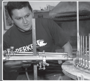
Hochwertige Verarbeitung durch hartgelötete Bauteile
